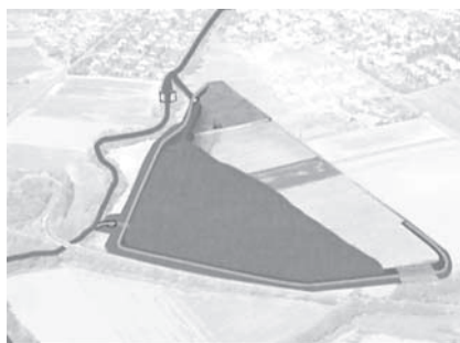
Schemat ideowy suchego polderu Schefferfeld w trakcie napełniania.
